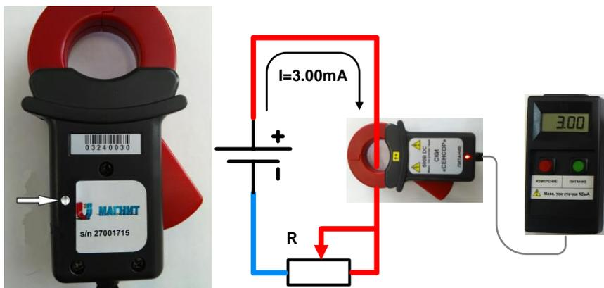
Рисунок 6. Калибровка токовых клещей.
