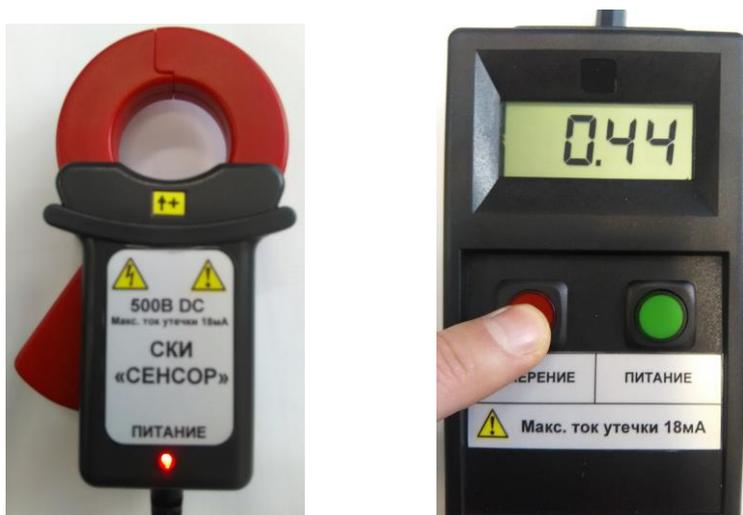
Рисунок 5. Ток утечки. Влияние магнитного поля земли.
