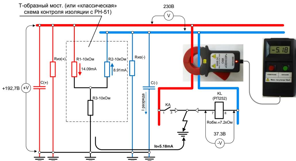
При возникновении «земли» в цепи управляющий контакт - обмотка реле, ток утечки  $I_0 = -5,18\text{mA}$  в установившемся режиме
