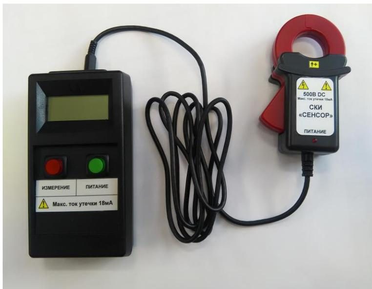
Рисунок 1. Переносное устройство контроля изоляции «СЕНСОР».
