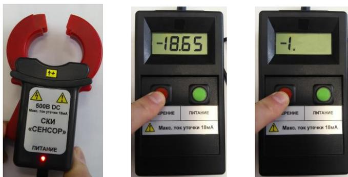
Рисунок 4. Контроль исправности токовых клещей (магнитопровод разомкнут).
